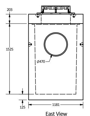
• 510 510 1525 Inlet: Ø470mm **Knockout Core** Outlet: Ø470mm Knockout Core 125 1820
